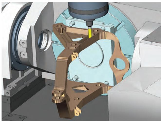
*Die Mastercam-Features „Rohteil“, „Abtragssimulation“ und „Simulation“ geben bei jedem Projekt mehr Sicherheit. Die Unterstützung von Werkzeugbibliotheken einschließlich CoroPlus® und MachiningCloud hilft bei schnellen Werkzeugbedarfs-Entscheidungen.*
